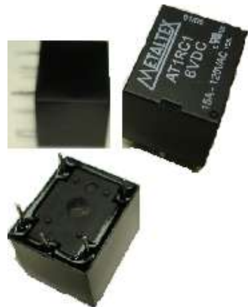
Observação da pinagem de um relé comutador.
