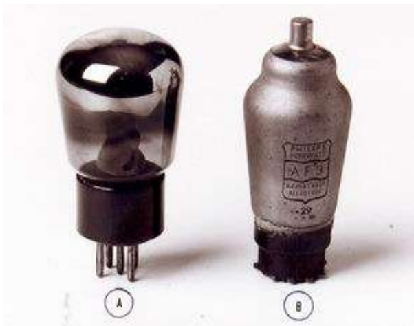
Válvulas tipo pentodo de origem européia fabricadas pela Philips entre 1928-1935: a) tipo B433 primeira válvula tipo pentodo fabricada no mundo b) tipo AF-3 pentodo de um variável para RF com soquete tipo P
