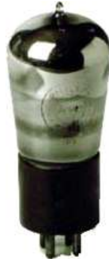
Tétodo de origem européia tipo A442 usado em estágios de RF, fabricado pela Philips em 1928
